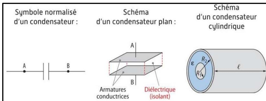
La charge  $q$  d'un condensateur est proportionnelle à la tension à ses bornes, ainsi :
